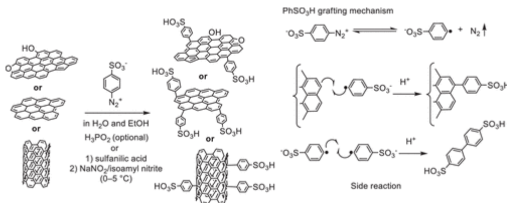
图 6.通过电化学或化学还原法获得磺化炭材料的后嫁接磺化方法示意图。
