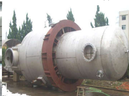
图 8 碳纤维复合材料储罐
